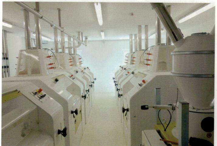
Abb. 2: Die Forstner-Mühle wurde mit sieben neuen Walzenstühlen vom Typ „Phenomill“ ausgestattet.
