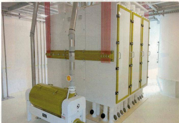
Abb. 3: Der Quadratplansichter vom Typ 624 ist auf 16 Passagen ausgelegt.
