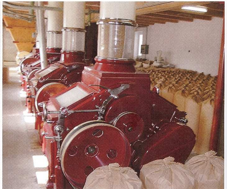
Stippenprobe: Bei der Stippenprobe wird die Qualität des Mehls überprüft. Die Walzenstühle zerkleinern das Getreide in mehreren Arbeitsschritten.
