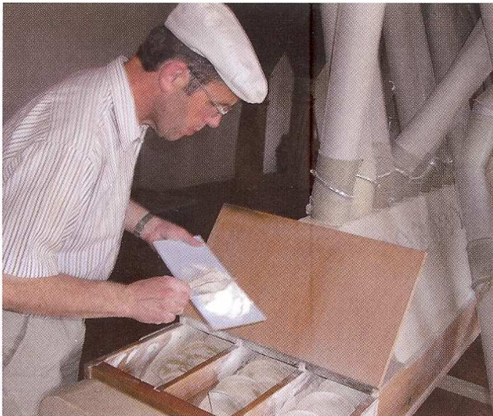
Stippenprobe: Bei der Stippenprobe wird die Qualität des Mehls überprüft. Die Walzenstühle zerkleinern das Getreide in mehreren Arbeitsschritten.
